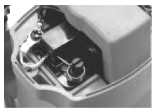
Графитните четки са нормална износваща се част и трябва да се сменят когато достигнат своя лимит на износване.
